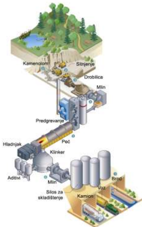
Слика 4.1 Графички приказ технолошког процеса у производњи цемента
